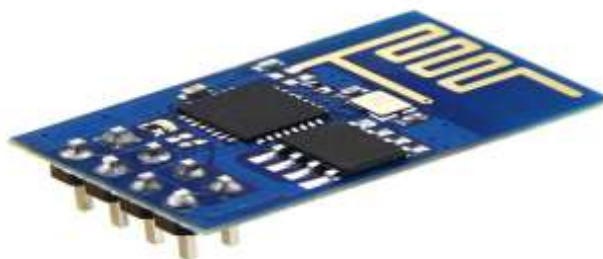
Fig. 2: ESP8266 Wi-Fi Module
